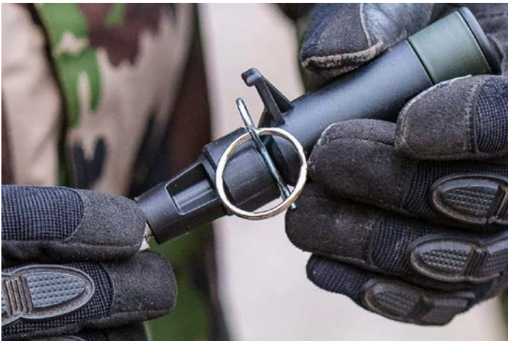
Die Mechanische Schlagvorrichtung 09 ist eines von mehreren möglichen Mitteln, um die Zündung zu betätigen.
