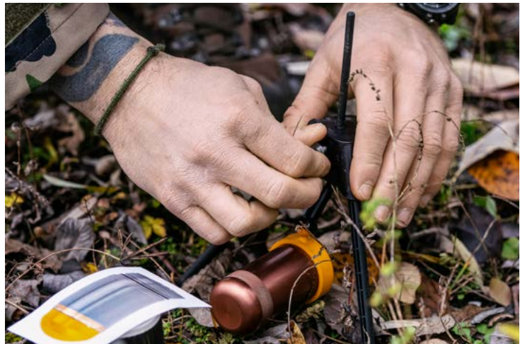
Die Beseitigungsladung wird mithilfe eines Dreibeins optimal auf den Blindgänger ausgerichtet.
